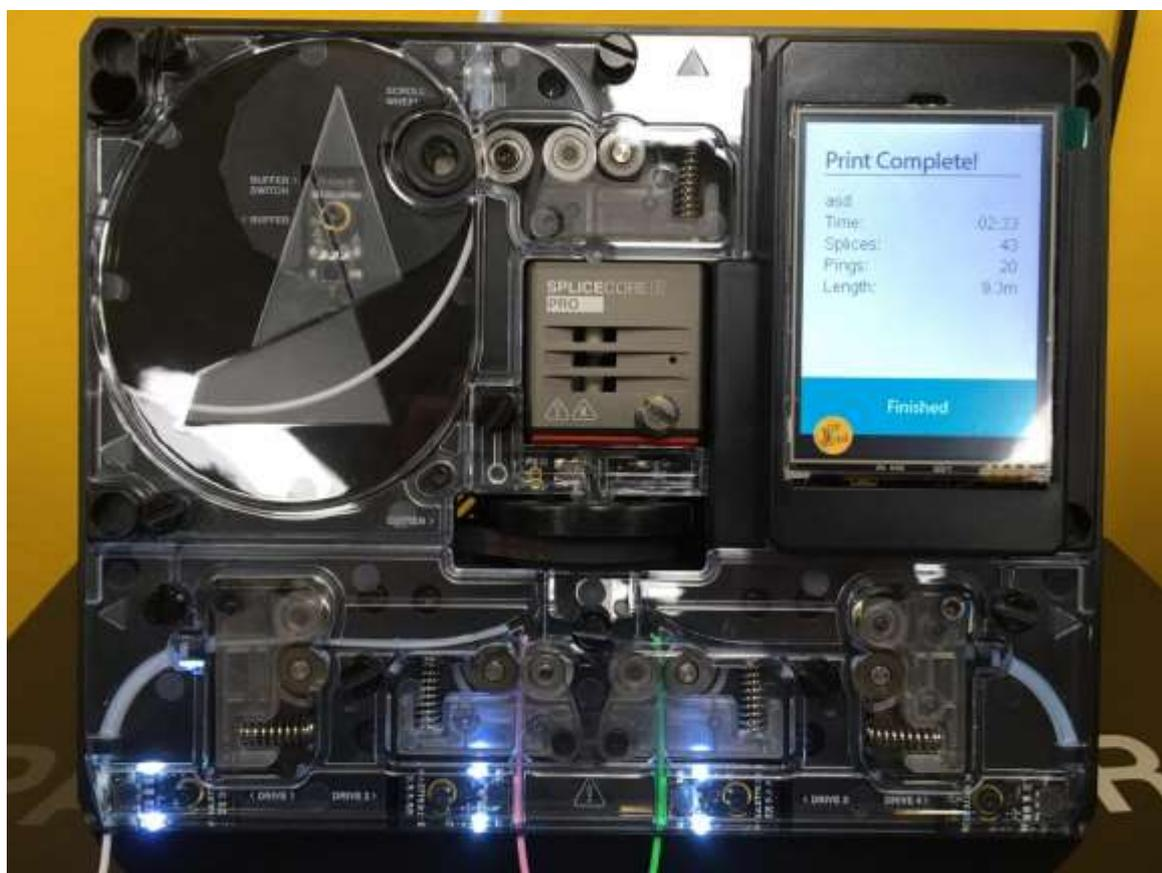
11. 待最後的線材完全離開機器後，選擇「Controls」進入進退料畫面，再選擇「Clear Output」將線材全部退至齒輪外，其中第一線及第四線需要退兩次才能完全退出，請勿強硬拉扯線材。
