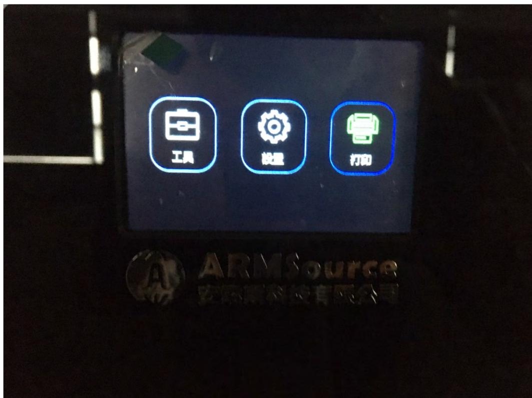
2. 有移動機台或是地震後等情況，需先至「工具→自動調平」並依指示放入 A4 紙張，待噴頭停止後抽動紙張調整 Z 軸高度。
