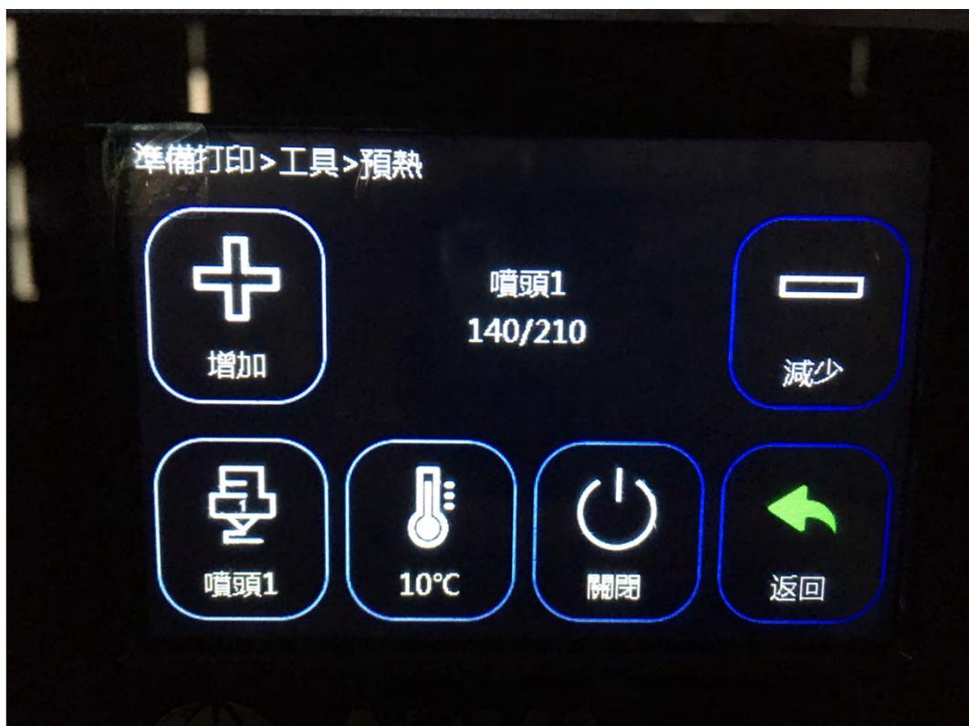
4. 至「工具→預熱→噴頭 1」調整熱床溫度，此時可選擇下方溫度計圖示，由一次調整 1°C 改為調整 10°C，並按下增加至所需溫度「目前溫度/所需溫度」。
