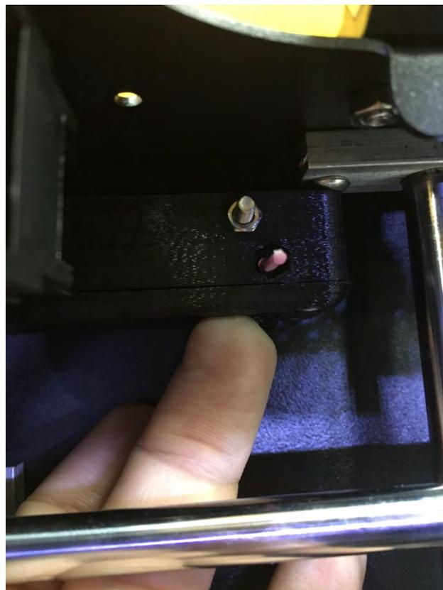
6. 插入線材，並按下右方彈簧處將線材推至最下方，待噴頭溫度足夠時會自動擠出耗材的狀態即可。
