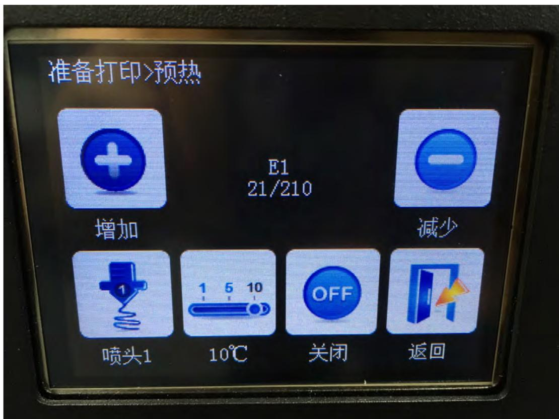
4. 至「預熱→噴頭 1」調整熱床溫度，此時可選擇下方溫度計圖示，由一次調整 1°C 改為調整 10 °C，並按下增加至所需溫度「目前溫度/所需溫度」。
