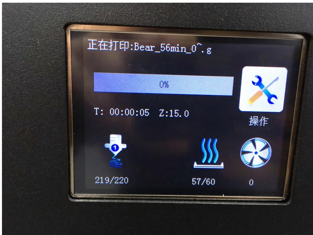
9. 請在列印至少 4~5 層底座後，確定模型有印在熱床上。
