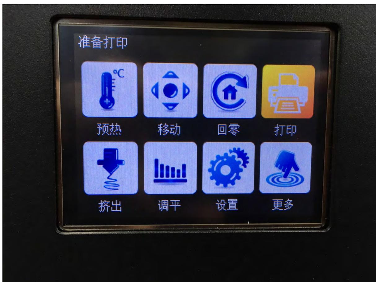
2. 有移動機台或是地震後等情況，需先至「調平」依序按下第一點，並放入 A4 紙張，待噴頭停止後抽動紙張確認是否已調整完成。移動停止後再按下第二點，直至第四點為止。
